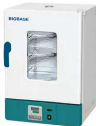
Horno de secado con aire forzado
