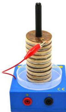
Aparato de pilote Volta
