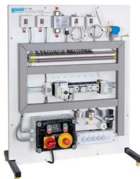
Instalación eléctrica en sistemas de refrigeración
