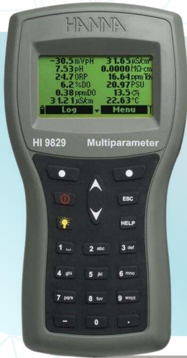
El HI9829 es un medidor multiparamétrico de registro portátil a prueba de agua que monitorea hasta 14 parámetros diferentes de calidad del agua. La sonda multisensor basada en microprocesador permite medir parámetros clave, incluidos pH, ORP, conductividad, oxígeno disuelto, turbidez, amonio, cloruro, nitrato y temperatura.
